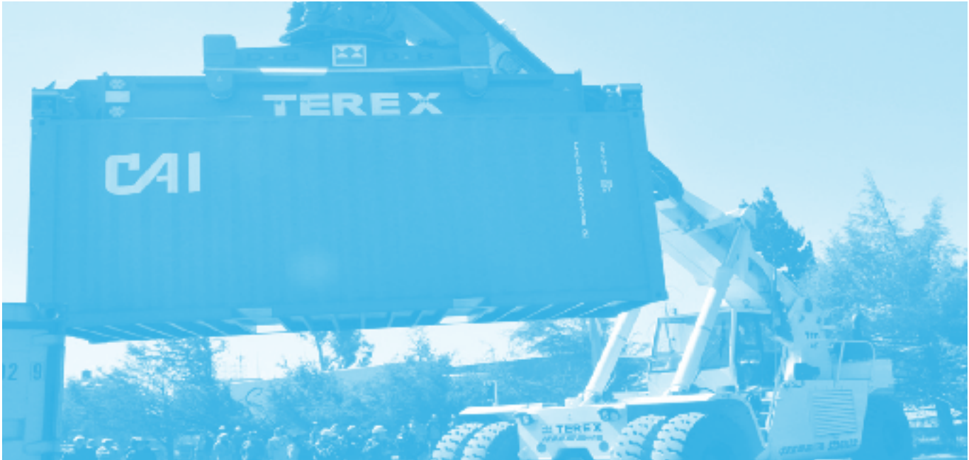
La nueva grúa Portacontenedores TEREX TFC 45, adquirida por DAB, tiene una capacidad de carga de 40 a 45 toneladas
